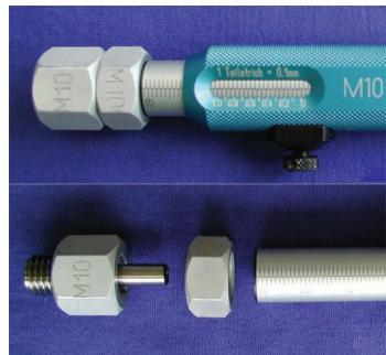
6. El calibre tampón para roscas Pasa-No Pasa se introduce en el cono del pivoté, se presiona y se fija mediante un golpe ligero con un martillo blando
