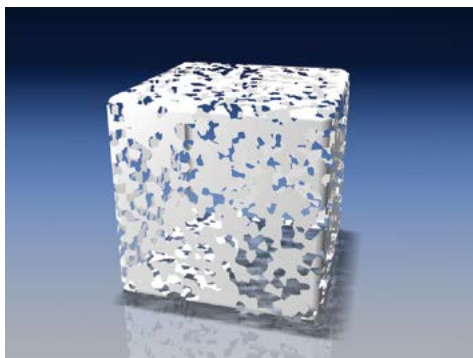
Рисунок 3. Слева: пористая наружная керамическая поверхность, справа: MMC — расплавленный металл, преимущественно алюминий или магний, заполняет поры, надёжно связывая керамические частицы.
